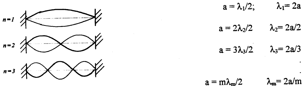
Rys.14. Fale stojące w strunie o długości a
